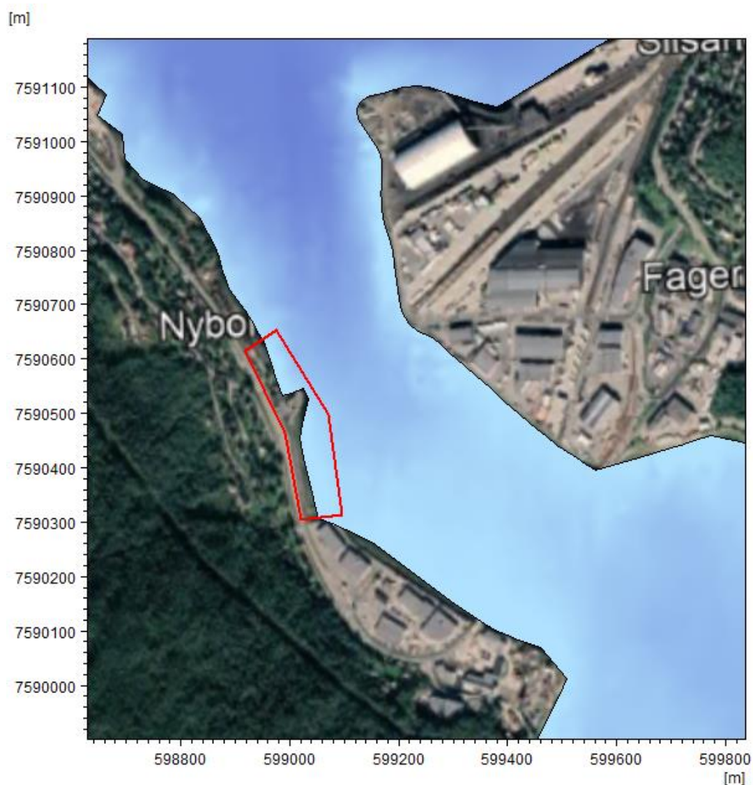
Figur 1-4: Omtrentlig afgrænsning af det nye planlagte udfyldningsområde ved Ankenesstrand. Området benævnes "Udfyldning B" i det følgende. Baggrundsfoto er fra (Google Earth, 2023).
