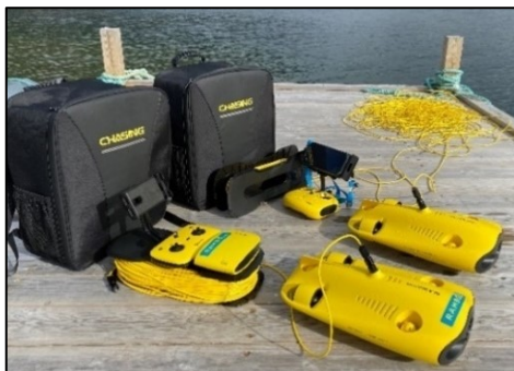
Figur 3-1. Undervannsdroner brukt til dronebefaring i Narvikbukta, januar 2022.
