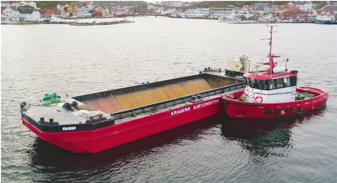
Figur 2 Splittlekter med lastkapasitet 200 tonn: Kragerø sjøtjeneste.
