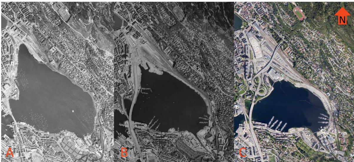
Figur 2: Gradvis utfylling i Store Lungegårdsvann, her valgt ut bilder fra (A) 1951, (B) 1980 og (C) 2019. Historiske bilder, tilgjengeliggjort av Norgebilder.no.
