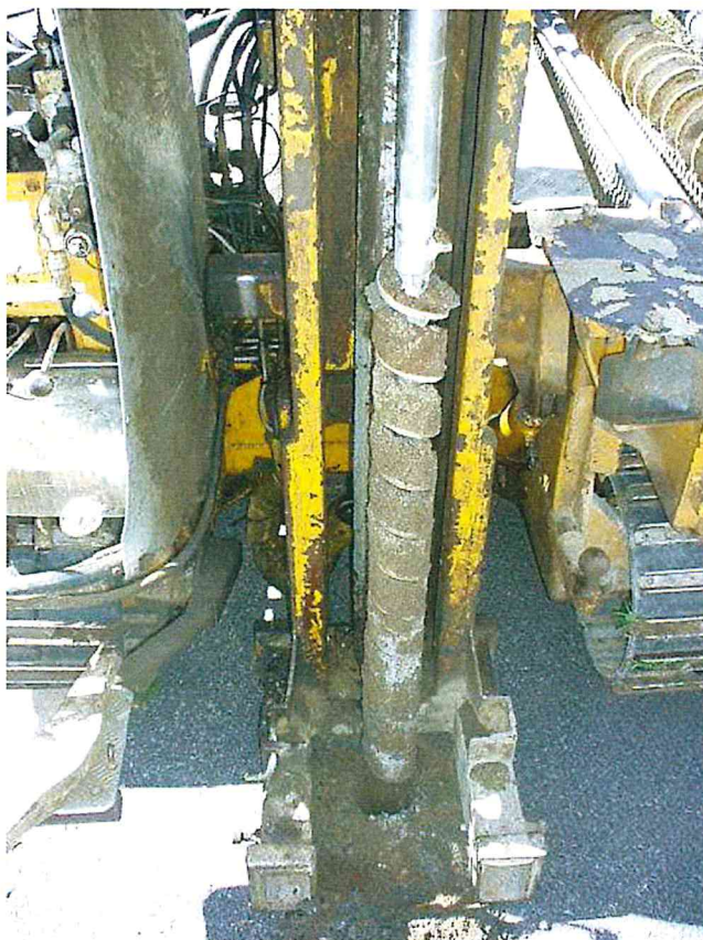
Figur 4: Bilde viser boreriggen med skovelbor. Skovelboret er skrudd ned en meter i nye masser, og så trukket rett ut av hullet. Metoden er rask og effektiv, og gir liten ødeleggelse av overflaten.
