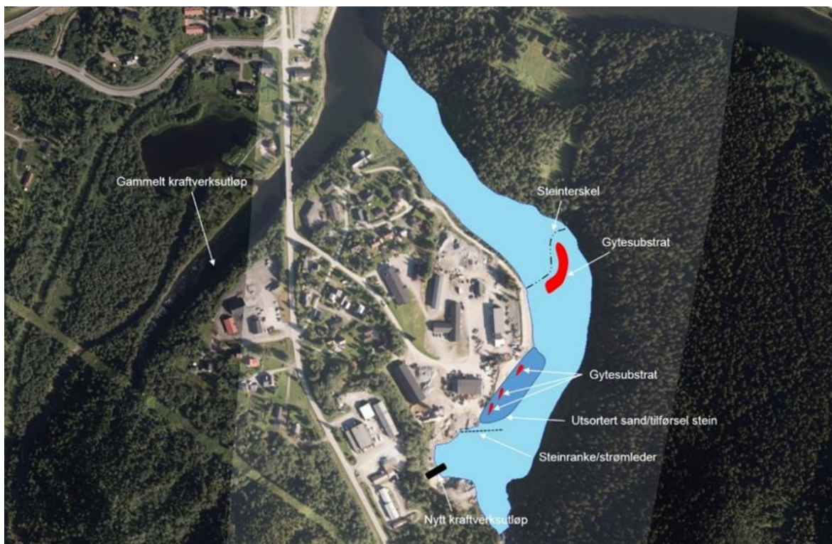
Figur 3. Prinsippskisse for arbeidet knyttet til tiltaksområdet mellom nytt og gammel kraftverksutløp i Røssåga. Spredt utlegg av steinblokk nedstrøms steinterskel er ikke tegnet inn. Skissen er hentet fra Kanstad-Hanssen mfl. (2015).
