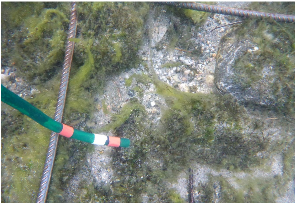
Bilde 1. Måling av hulrom i elvebunnen skjedde ved hjelp av fleksibel plastslange i henhold til metode beskrevet av Finstad mfl. (2007). Foto: Jan Gunnar Jensås.
