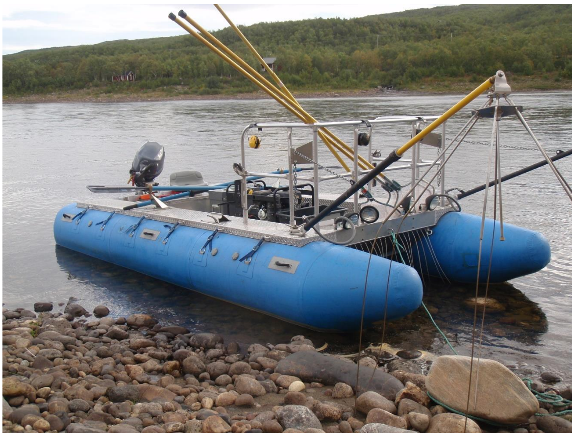
Bilde 3. I 2020 ble det benyttet en mindre RIB-båt under det elektriske båtfisket i Røssåga. Denne båten kan operere i betydelig grunnere områder enn den store båten. Illustrasjonsbildet er fra en tilsvarende undersøkelse i Tanaelva i september 2014. Foto: Gunnbjørn Bremset.
