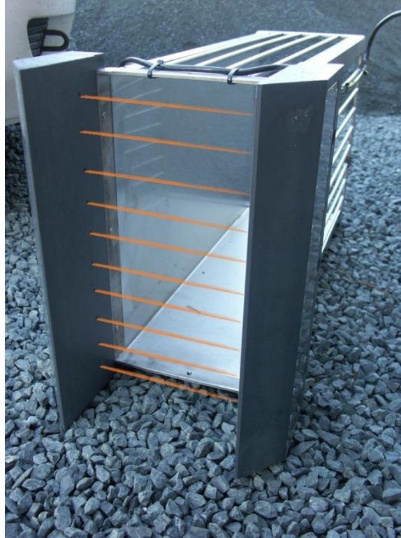
Figur 2. Optisk sensor montert i enden av avbildningskammeret. Lysstrålene som sendes ut av dioder på den ene siden av sensoren er egentlig IR-lys som ikke er synlig. På bildet er lysstrålene illustrert med oransje streker.
