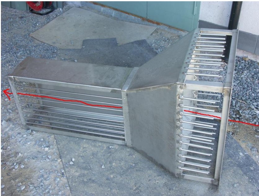
Figur 1. Passeringskanal for fisketelling i fisketrapp. Den røde pilen angir passeringsretning på vei opp eleven. Optisk sensor monteres på enden av avbildningskammeret (til venstre) og er ikke montert på telleren på bildet.
