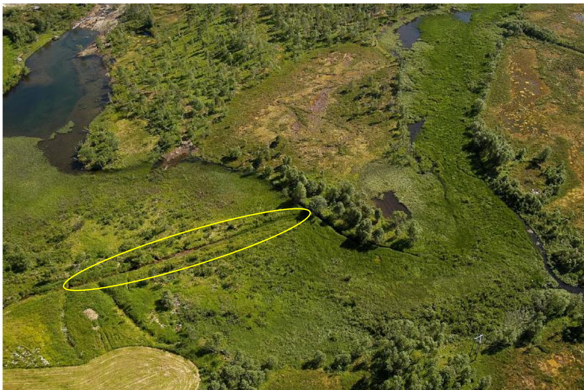
Figur 3. Flyfoto av øvre deler av Børselva som viser hvordan vassdraget er fylt opp av finmasser fra kanalen fra Bruksåsmoen og er gjengrodd med vannplanter. I forbindelse med rehabiliteringen av kanalen ble det gravd et nytt løp (markert med gult) frem til «Børselva».
