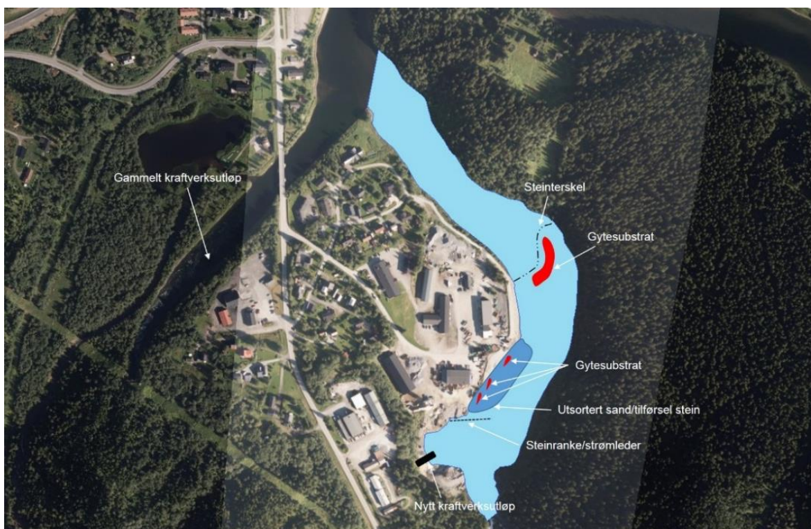
Figur 2. Prinsippskisse for arbeider knyttet til tiltaksområdet mellom nytt og gammel kraftverksutløp i Røssåga. Spredt utlegg av steinblokk nedstrøms steinterskel er ikke tegnet inn. Skissen er hentet fra Kanstad-Hanssen mfl. (2015).
