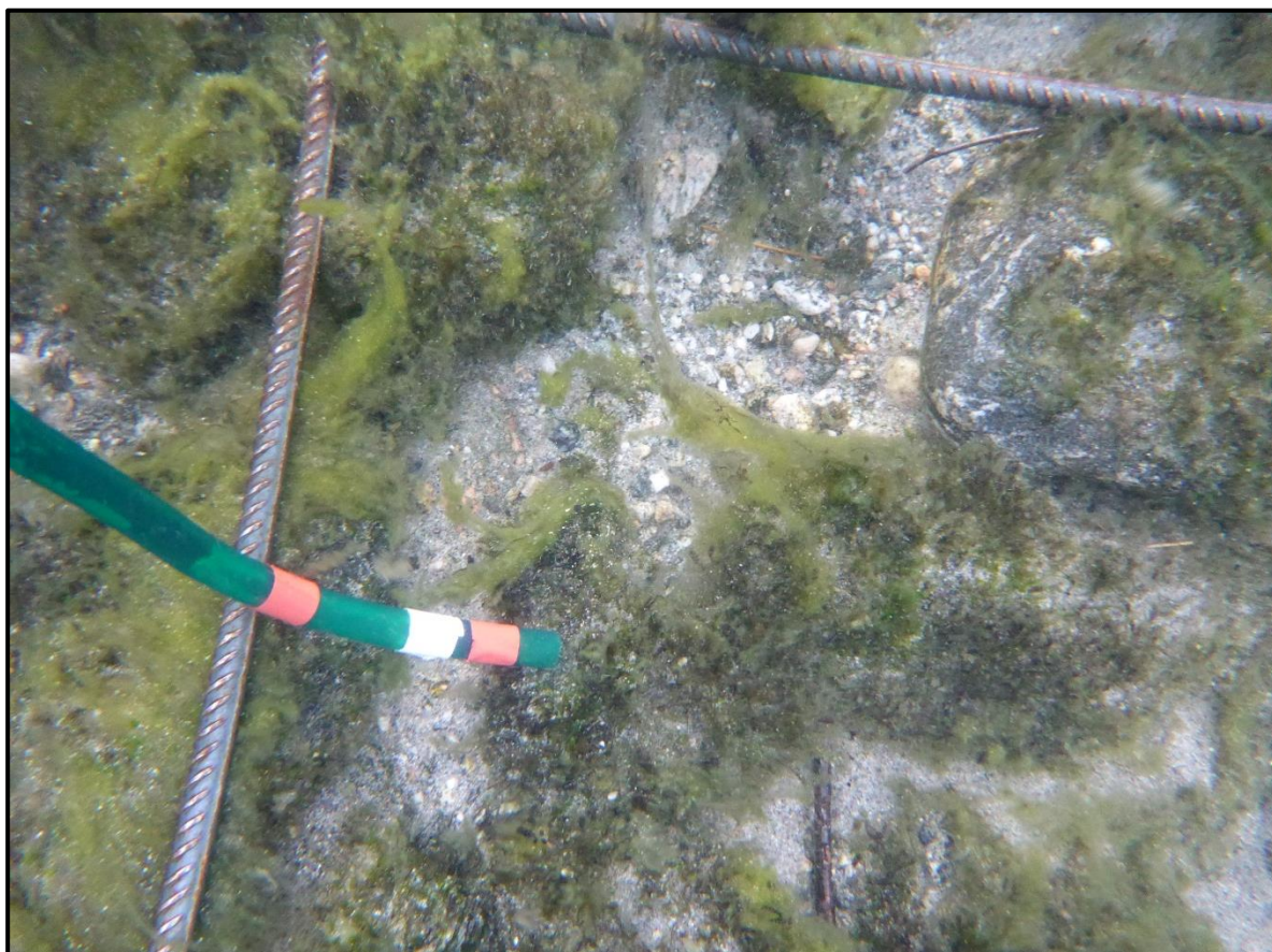
Bilde 1. Måling av hulrom ved hjelp av fleksibel plastslange etter metode beskrevet av Finstad mfl. (2007). Foto: Jan Gunnar Jensås, NINA.
