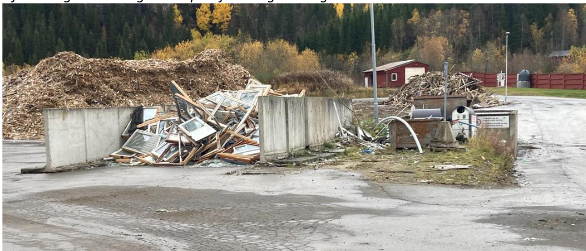
Figur 1: Klorparafinholdige isolerglass i binge uten tak, flere er knust, og haug med impregnert trevirke i bakgrunnen til høyre
