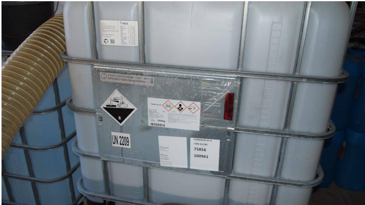
Bilde 8. IBC-kontainer med formalin. Plassert i garasje med avløp.
