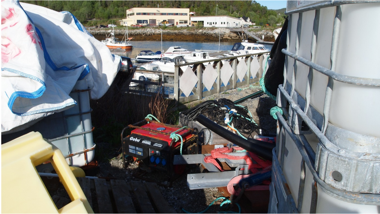
Bilde 3. Strømaggregat og elektrisk avfall lagret utendørs med fare for avrenning til grunn.
