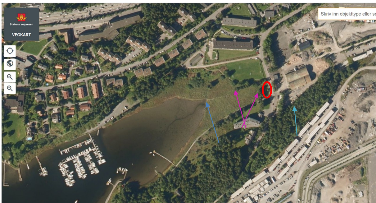
Figur 8 Holtekilen i Bærum, vegkart.no Dagens situasjon med omtrentlig plassering av utløp og terreng omtalt i teksten. Utløpet av Ø600 (overvannsledning, nødoverløp for spillvann) markert med oransje pil. Bekkesig ned mot Holtekilen på nedsiden av Oksenøyveien markert med rosa piler, og historisk bekkeløp på oversiden av Oksenøyveien markert med blå pil. Ringen markerer området der overvann går ut, fra planlagt kulvert.
