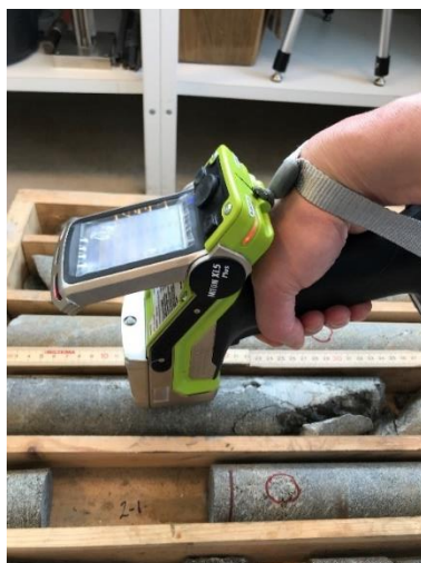
Figur 1: Analyse av bergkjerner utført med Håndholdt XRF på overflate.
