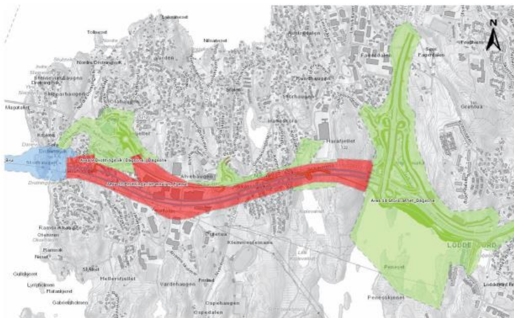
Figur 4. Oversiktskart som viser ulike delstrekninger på aktuell strekning. Drotningstunnelen er avmerket med rødt (A10), dagsoner med grønt (A9 og A11) og deler av ny Sotrabru (A8) med blått. Kilde: Multiconsult GIS-modell.
