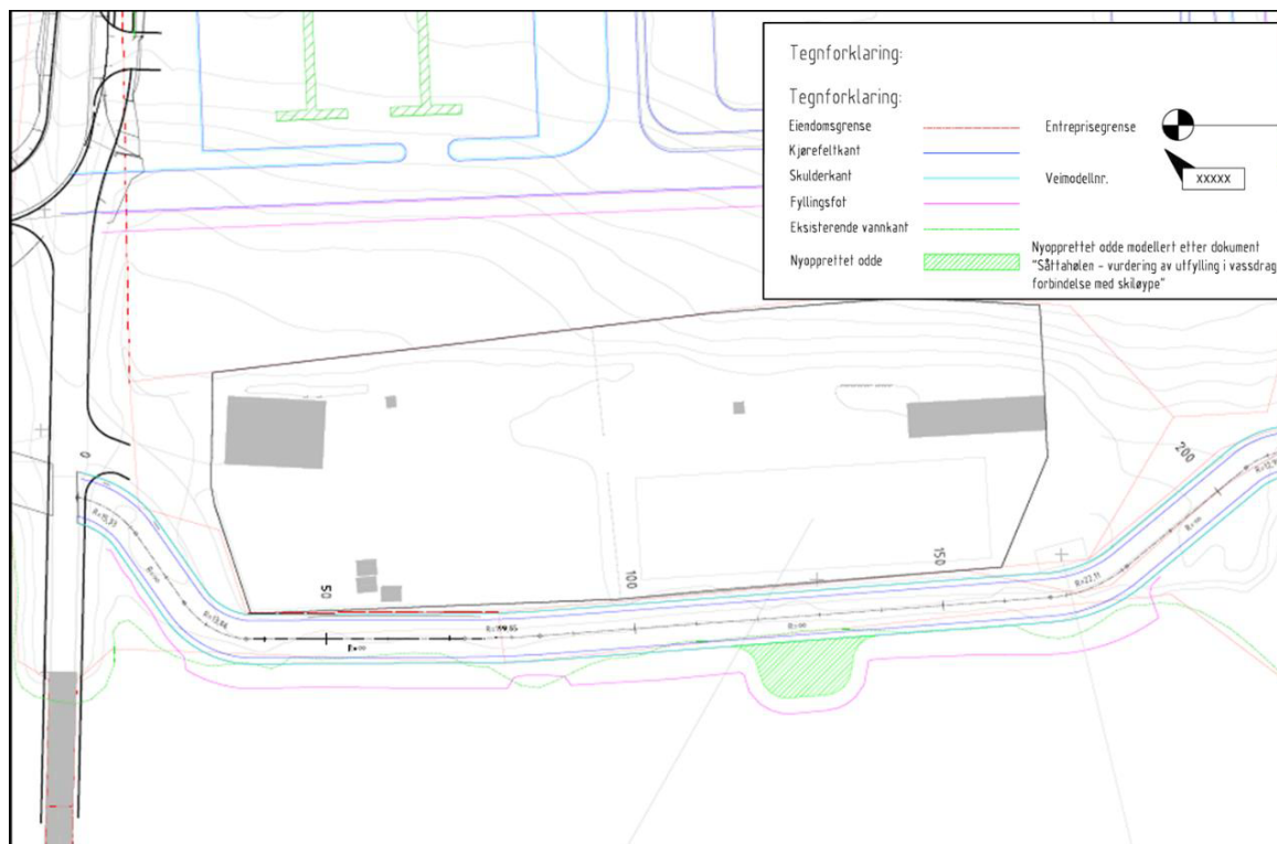
Figur 1-3: Utklippsbilde av plantegning. Tegning viser hvor fremtidig fyllingsfot vil ligge i forhold til eksisterende vannkant.
