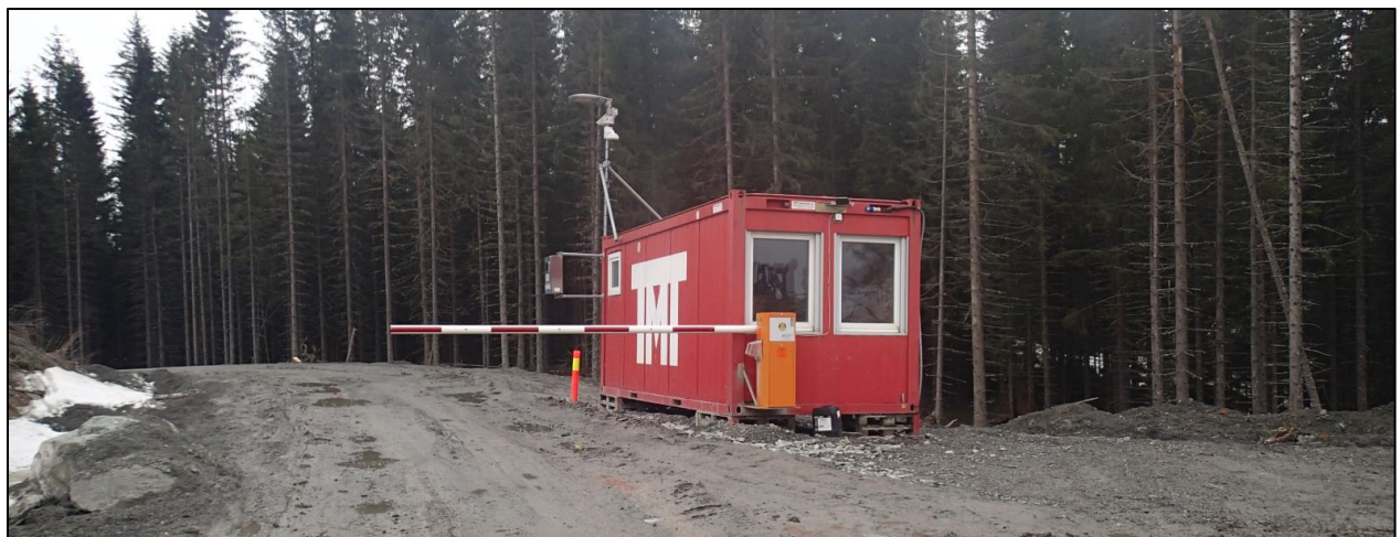
Figur 2. Bomstasjon for registrering av innkjørte masser til deponi, her fra Drage deponi.
