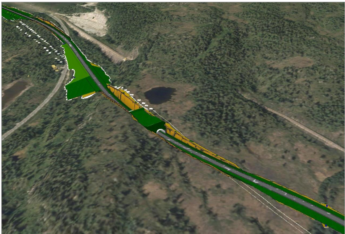
Figur 6-7. Utsnitt fra prosjekteringsmodellen hentet fra søknaden om omlegging av flyttleia (Statens vegvesen, 2020b) som viser økoduksens plassering litt sør for toppen av landskapsryggen, hvor flyttleia opprinnelig gikk. Jernbanetunnelen rett øst for tjernet er en naturlig landskapspassasje over Nordlandsbanen. Sammen legger overgangene til rette for at reinen kan krysse E6 og jernbanen planfritt.
