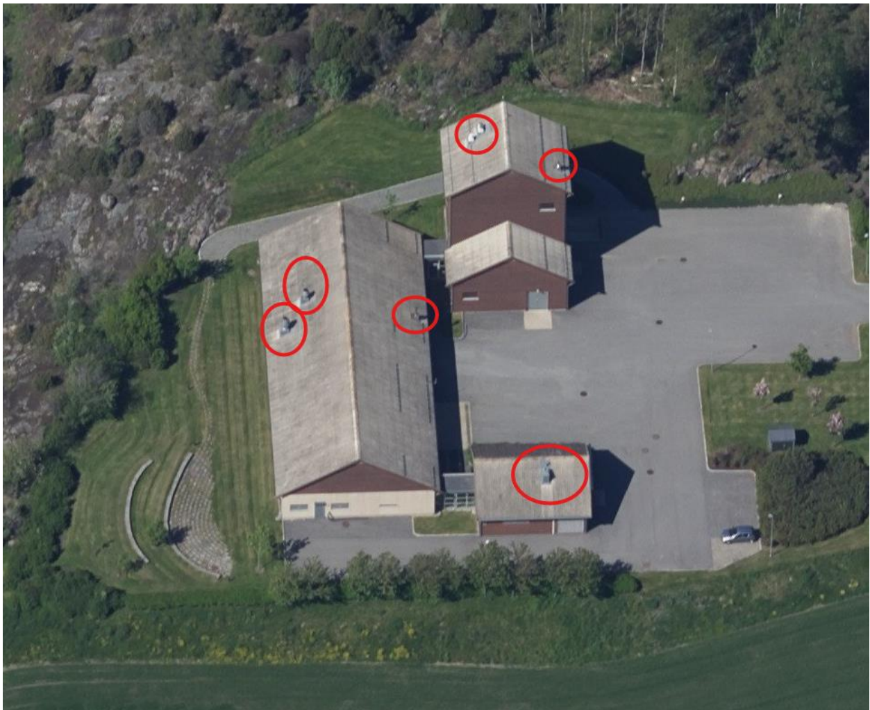
Figur 10. Avtrekkshetter med utslipp til luft ved Hestevold RA er markert med rød sirkel.
