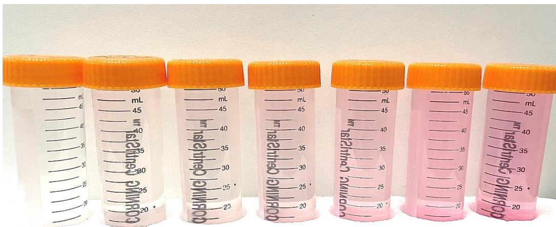
Figur 13. Standardene ble lagd ferske hver morgen og dannet beregningsgrunnlag for klorkonsentrasjonene som ble målt utover dagen. Foto: Marit Måsøy Amundsen/Veterinærinstituttet
