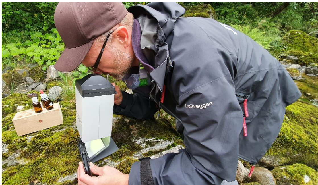
Figur 14. Avlesing av estimert klorkonsentrasjon ved hjelp av komparator. Foto: Kjetil Olstad/NINA
