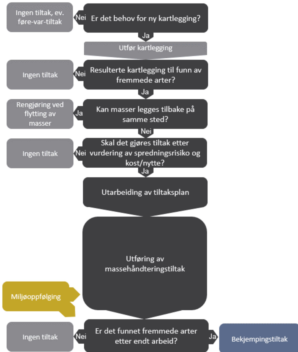
Figur 3. Flytskjema som forklarer alle trinnene man må gjennom for å håndtere masser med fremmede arter i prosjekt.
