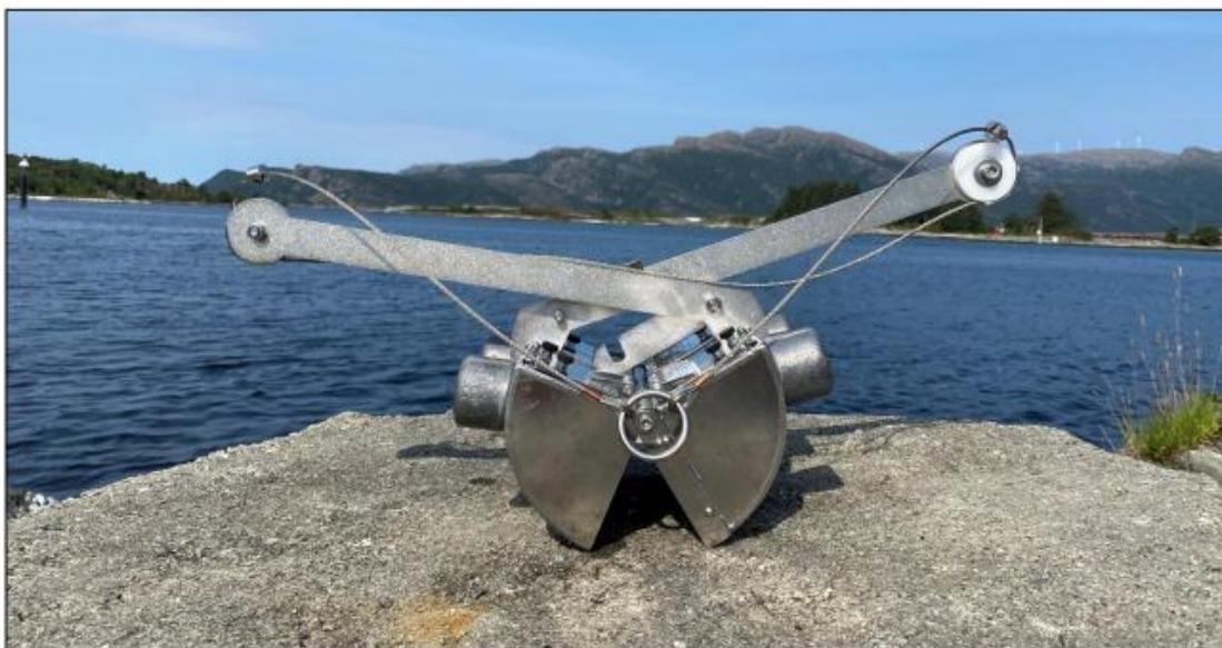
Figur 2: Van veen grabb, egnet for prøvetaking av sediment.
