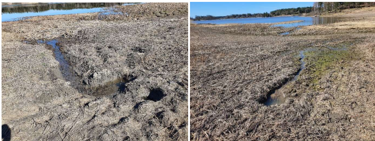
Synkehull, erosjon og fuktige partier årsaket av dykkede utløpsrør
