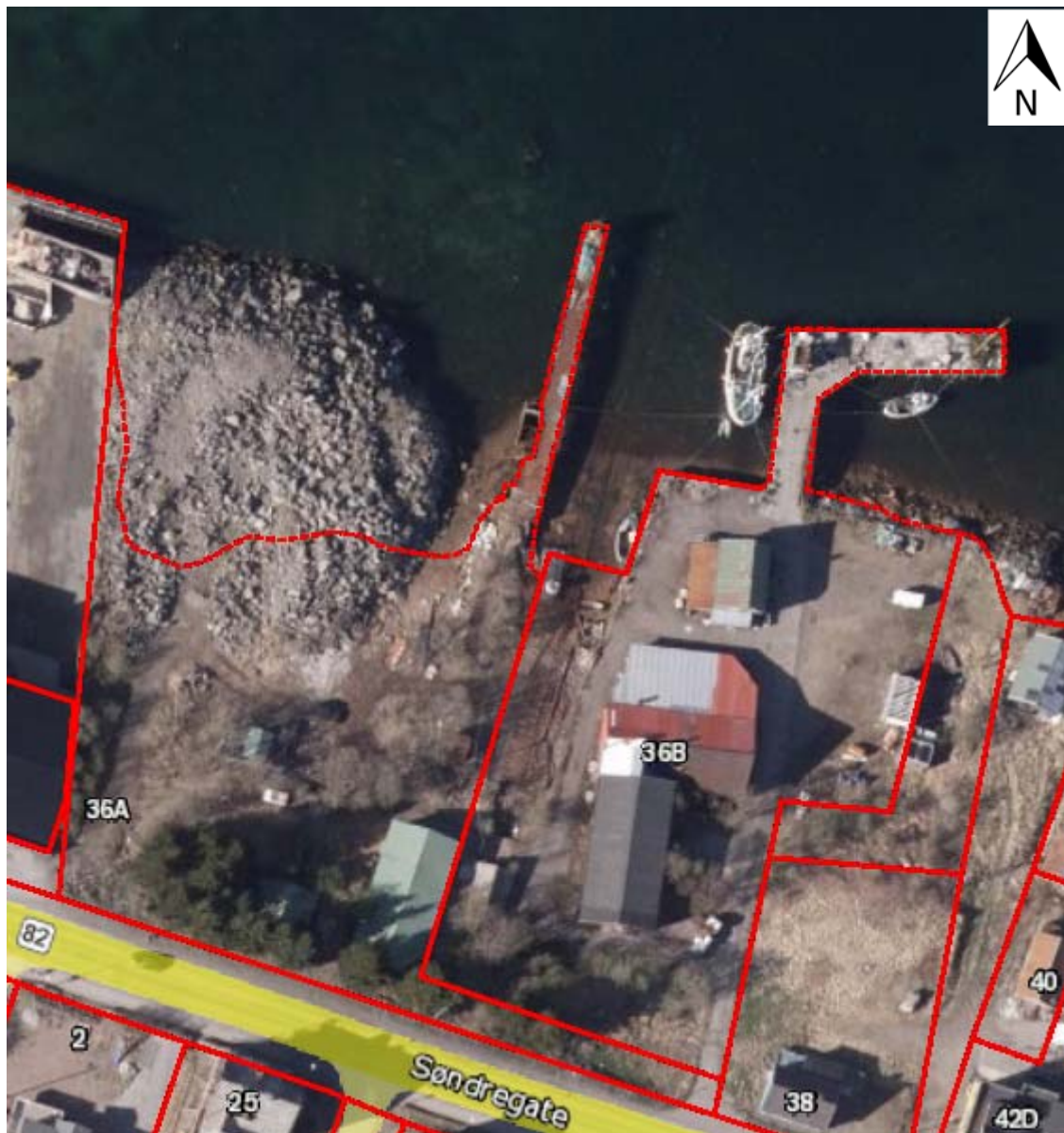
Figur 2-2: Søndre gate 36 i Hadsel kommune. Det er eksisterende fyllinger i sjø på øst- og vestsiden av tomten. Båtslipp, kai og bygninger på eiendommen er fjernet. Kartkilde: Arcgis.
