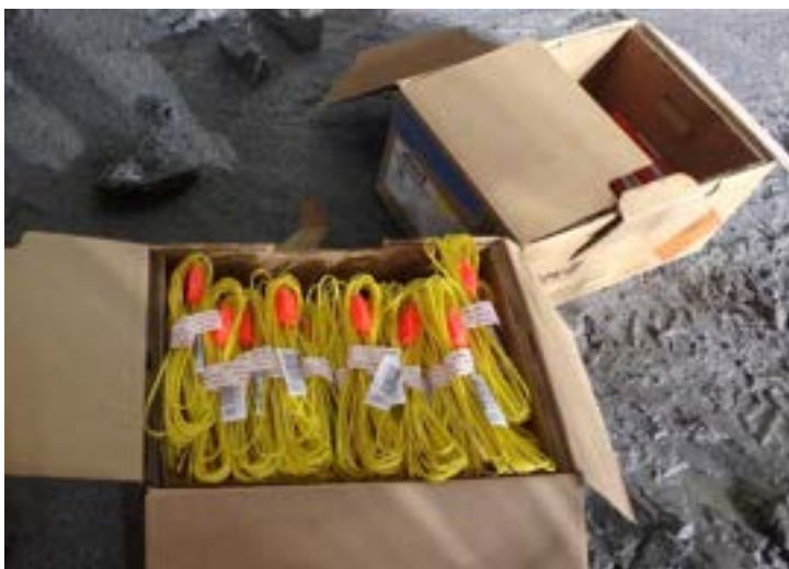
Figur 2: Elektroniske tennere – rød koblingsboks, gul skyteledning (metalltråd kledt med plast) og hvit «tag» med Id-nr på hver enkelt tenner.
