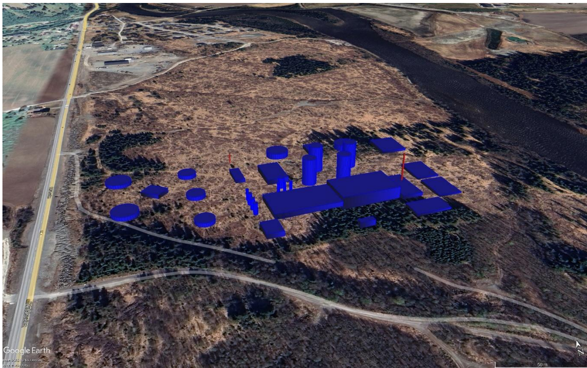
Figur 4. Visualisering av CALPUFF-modellen, som viser beregningsområdet med reseptor-grid og terrengkonturer (blå kryss; øverst), og utdrag fra modellen zoomet inn ved Gasum Vormstad (nederst; bygninger i modellen vist i blått og punktutslipp i rødt). Generert i Lakes CALPUFF View og, for 3D-bildet nederst, eksportert til Google Earth.
