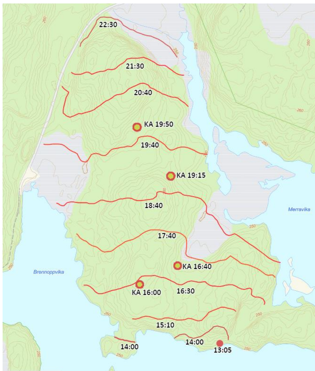
Figur 1 Antenningsmønster gjennom brenningsdagen. Rødt punkt – startsted brenning, Røde linjer – brannfront, KA – klusterantenne. * Brannfront 14:00 og 22:30 inntegnet skjønnsmessig. Øvrige brannfronter inntegnet med GPS-sporlogg på telefon med kartappen Norgeskart friluftsliv. Klokkeslettene viser når loggingen av brannfronten ble avsluttet.
