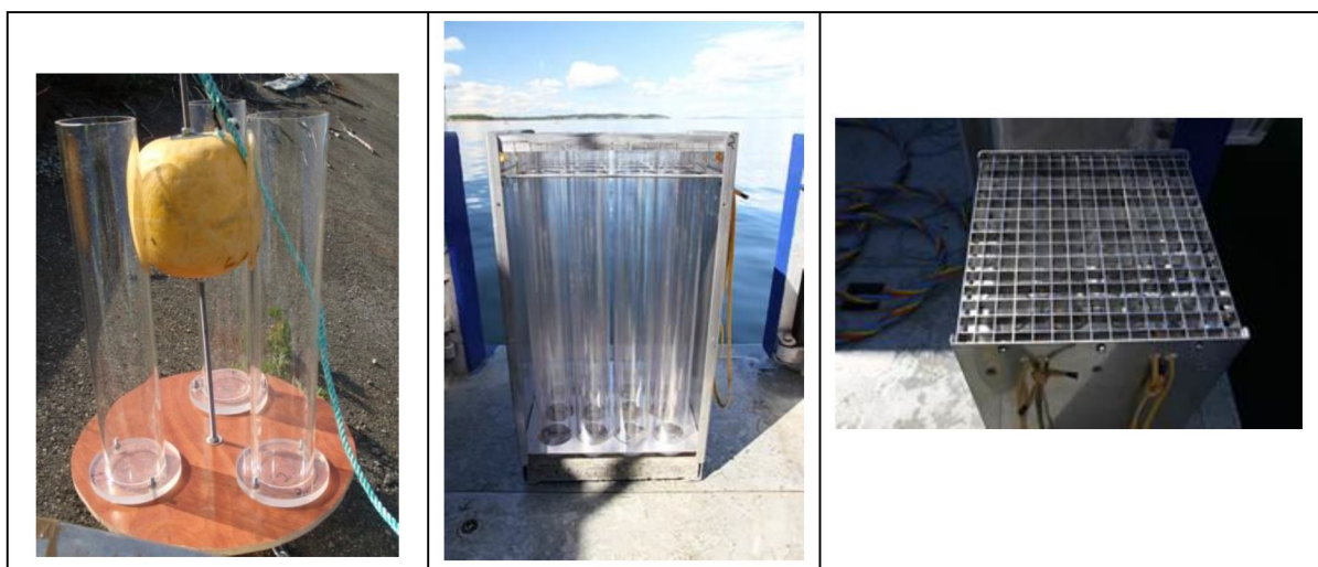
Figur 1 Eksempel på utforming av sedimentfeller. Bildet til venstre viser standard sedimentfelle som plasseres på bunnen eller i vannsøylen. Bildet i midten viser større sedimentfeller for plassering på bunn og detalj som viser åpning med strømdemper er vist i bildet til høyre.
