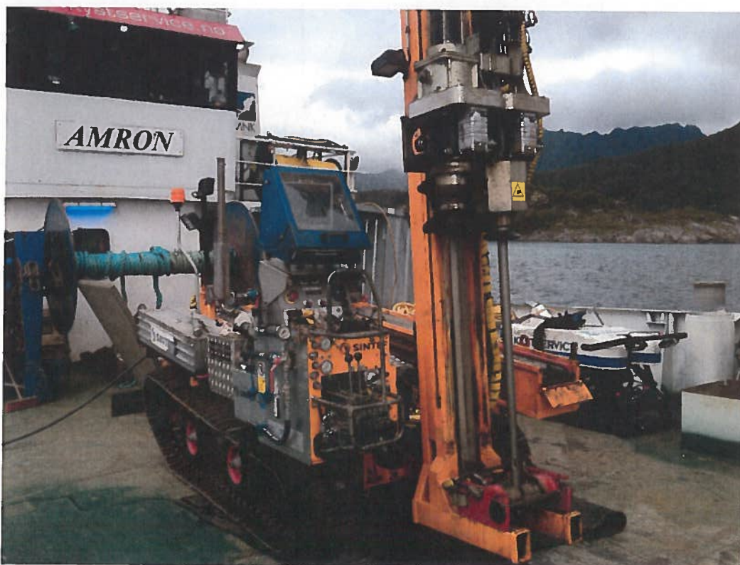
Figur 12 Borerigg Geotech 504 ombord på Amron.
