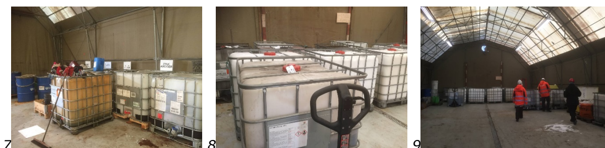
Figur 2, bilder av system for sortering og lagring av farlig avfall. Bilde 7 viser åpne IBC'er for lagring av fast avfall. Bilde 8 viser lukkede IBC'er for lagring av flytende avfall. Bilde 9 viser hall for lagring av farlig avfall.
