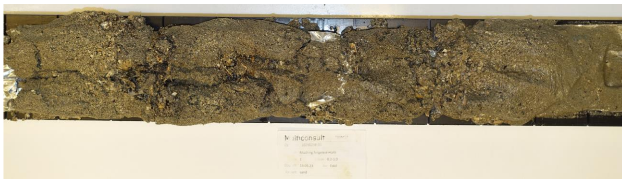
Figur 4: Sand med enkelte gruskorn, korall og skjellrester fra BP1 (0,2-1,0 m).
