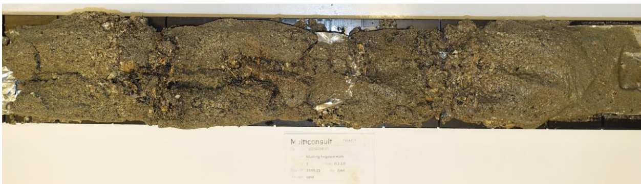
Figur 4-2: Sand med enkelte gruskorn, korall og skjellrester fra borpunkt 1 ved 0,2-1,0 m dybde.
