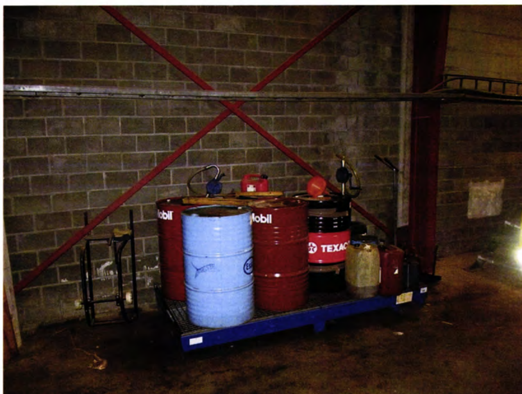
Figur 2.31: Oljeprodukter er lagret på oppsamlingsarrangement i nytt royalbygg
