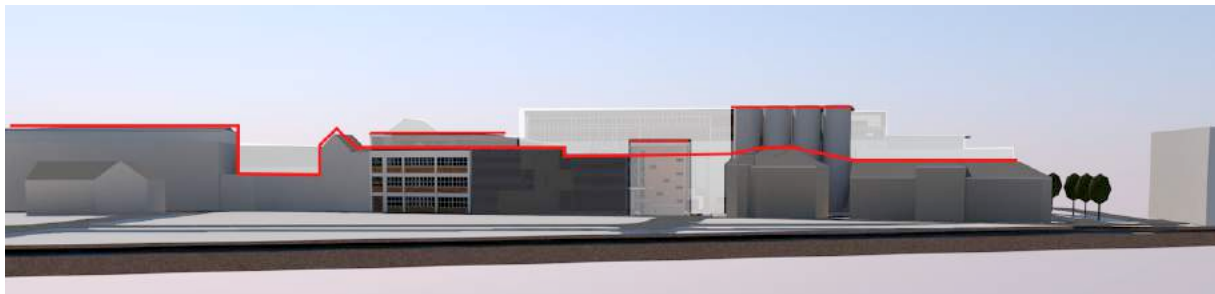
Fasade mot Ole Steens gate som viser de planlagte høydene for p-huset, kontorpåbygget og tankene.
