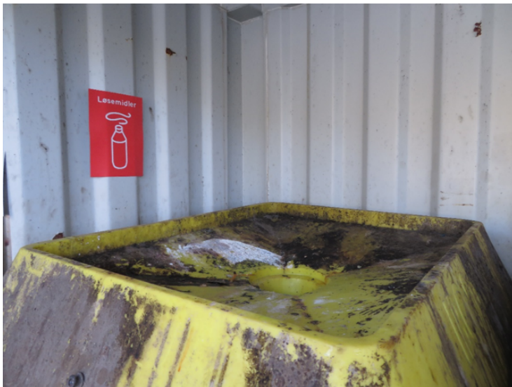
Figur 3: oppbevaringsløsning som legger opp til tømming av flytende farlig avfall over i IBC.
