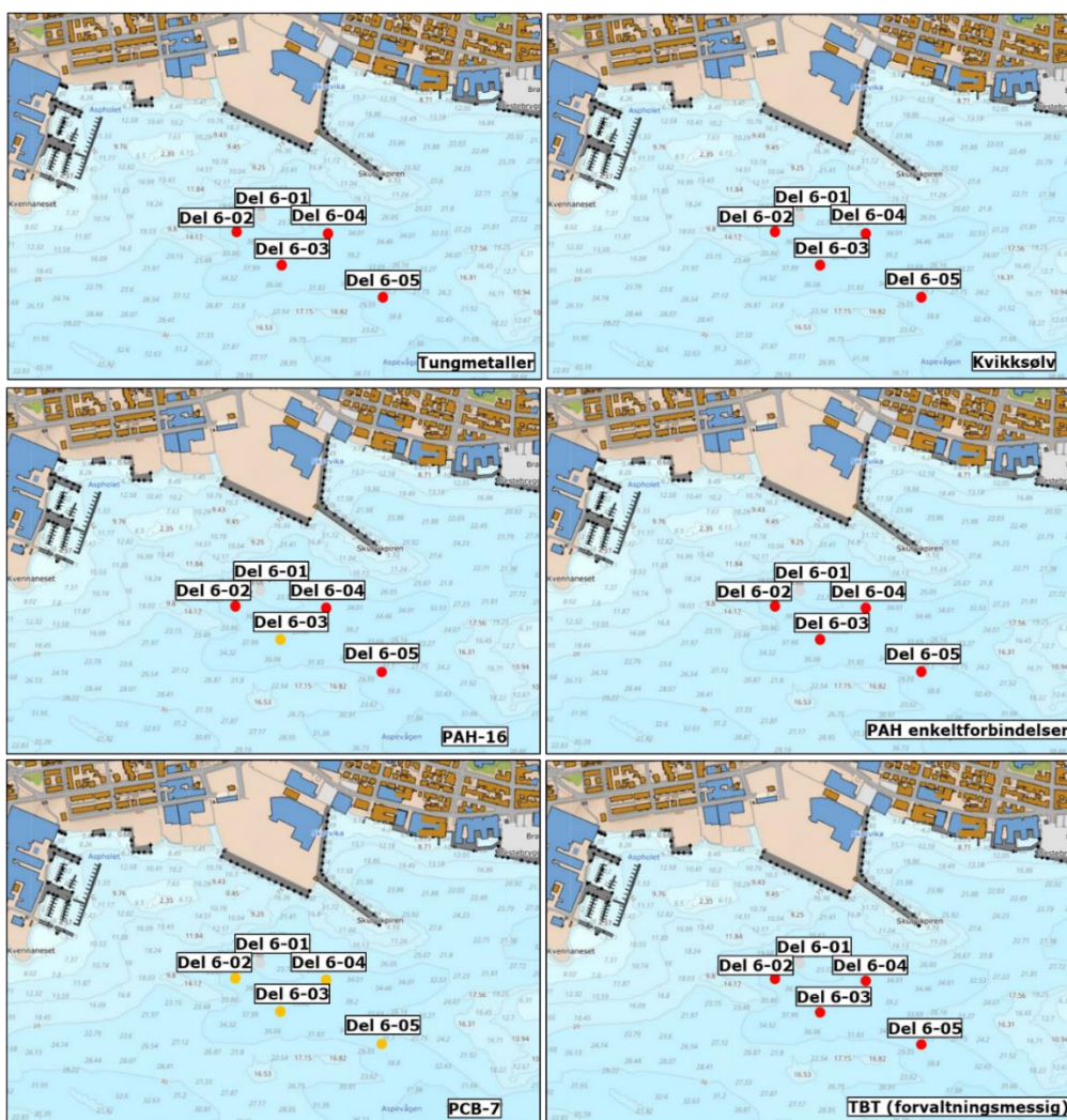
Figur 35. Illustrasjon av tilstandsklasser for tungmetaller (den dårligste tilstandsklassen for analyserte metaller), kvikksølv, PAH-16, PAH-enkeltforbindelser (den dårligste tilstandsklassen for de analyserte PAH-enkeltforbindelsene), PCB-7 og TBT (forvaltningsmessige tilstandsklassegrenser) på de ulike stasjonene i delområde 6 i Aspevågen i 2021. Fargekodene er forklart i Tabell 1.
