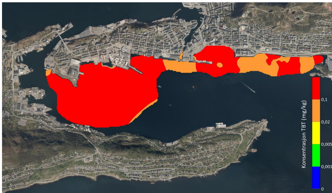
Figur 43. Interpolert utbredelse av TBT i overflatesedimentene i de undersøkte delområdene i Aspevågen i 2021 (inkl. prøver tatt av Multiconsult i 2019 (Multiconsult, 2020) ved Gassverkstomta). Fargene indikerer tilstandsklassen til den aktuelle parameteren (iht. veileder M-608/2016 rev. 2020 (Miljødirektoratet, 2020)); blå=svært god tilstand, grønn=god tilstand, gul=moderat tilstand, oransje=dårlig tilstand og rød=svært dårlig tilstand.
