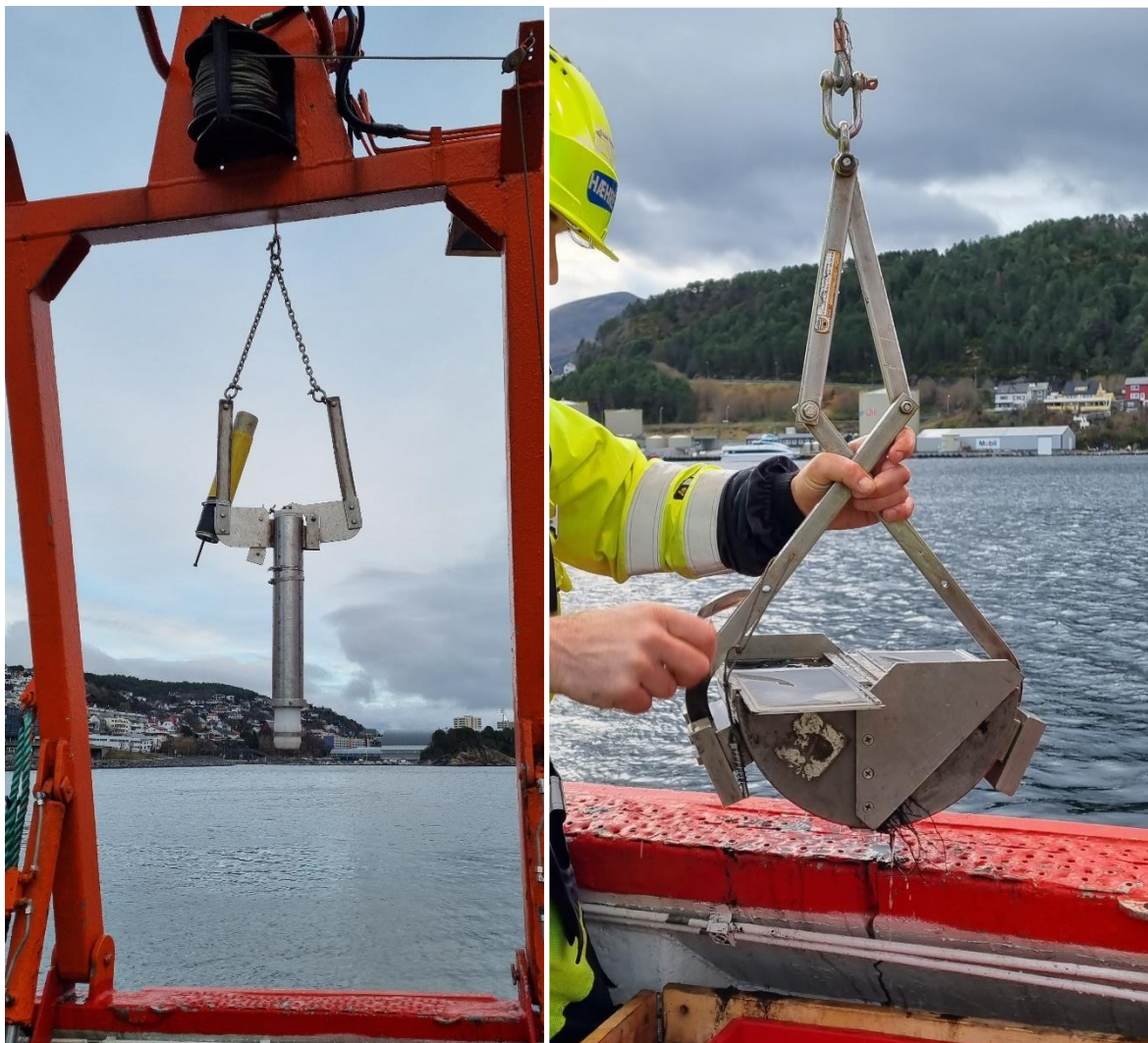
Figur 5. Venstre: En Abdullah-kjerneprøvetaker ble benyttet til å hente opp kjerneprøver av sediment. Høyre: Van Veen grabb.
