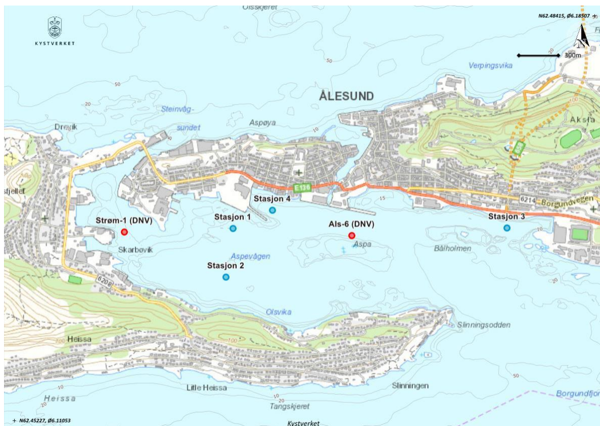
Figur 1. Strømmålingsstasjoner fra DNV (2010) vist med røde sirkler og Rambøll (2022) vist med blå sirkler.
