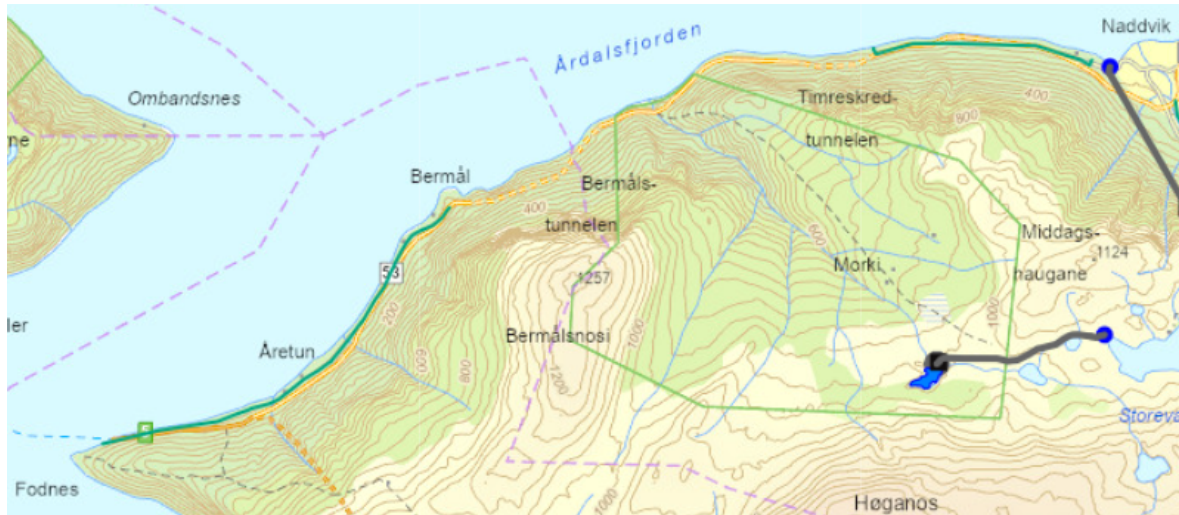
Figur 3 Synleggjering av kraftanlegga i området, der grønne linjer langs fjorden syner dagens kraftanlegg. Det er ikkje nettanlegg i drift mellom Bermål og utløpet av Timreskredtunnelen. Skogateigen er det trekanta arealet der det står Ber(målstun)elen. På vestsida av kommunegrensa (den lilla stipla linja) har Sygnir konsesjon, på austsida har Straumnett konsesjon. I sørvest ser ein ferjeleiet Fodnes. Kartet syner også pumpestasjonen og røryrgata frå Viervatn i naturreservatet mot aust til Storevatnet eigd av Østfold Energi. Kjelde: fylkesatlas
