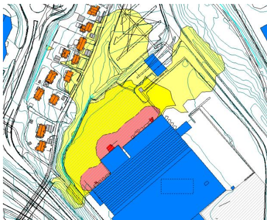
Figur 10: Beregnet maksimalt støynivå i forbindelse med lasting av tungtransport. Ytterkant gul støysone er L_{AFmax} = 60 dB.
