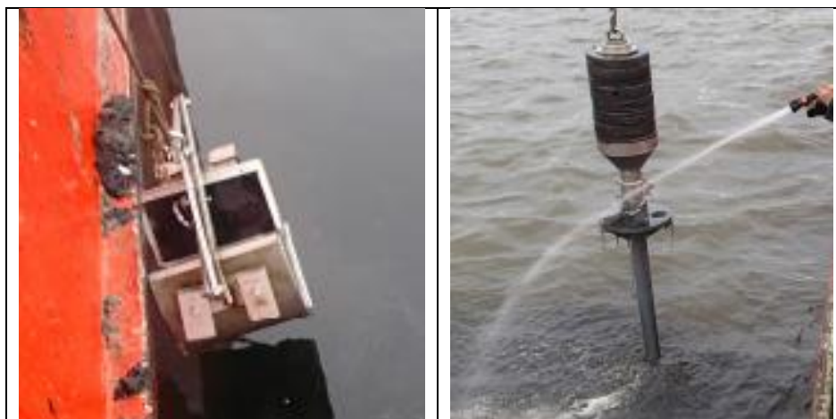
Figur 1. Van Veen grabb (bilde til venstre) benyttet til prøvetaking av overflatesedimenter (0-5 cm) og fallprøvetaker (bilde til høyre) benyttet til kjerneprøvetaking av sedimenter utenfor Vippetangkaia februar 2017.
