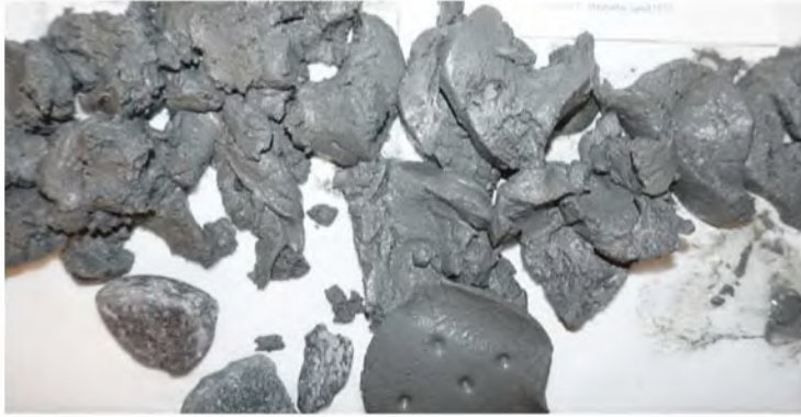
Figur 8: Bilde fra prøveåpning av BH.18, dybde 1,2-1,6m. Massene er siltig, sandig, leirig materiale med gruskorn.
