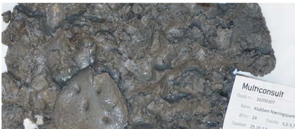
Figur 14: Bilde fra prøveåpning av BH.24, dybde 3,3-3,7m. Massene er humusholdig sandig, siltig, grusig, leirig materiale.
