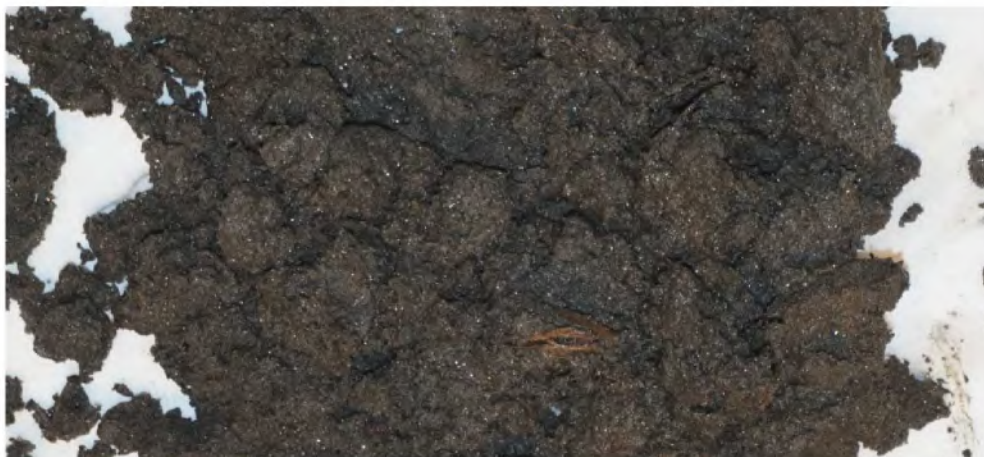
Figur 13: Bilde fra prøveåpning av BH.24, dybde 2,6-2,9m. Massene er humusholdig sand.
