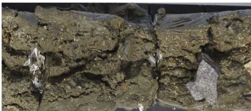
Figur 5: Bilde fra prøveåpning av BH.9, dybde 0,2-1,0m. Massene er siltig, sandig, grusig, leirig materiale med skjell og koraller.
