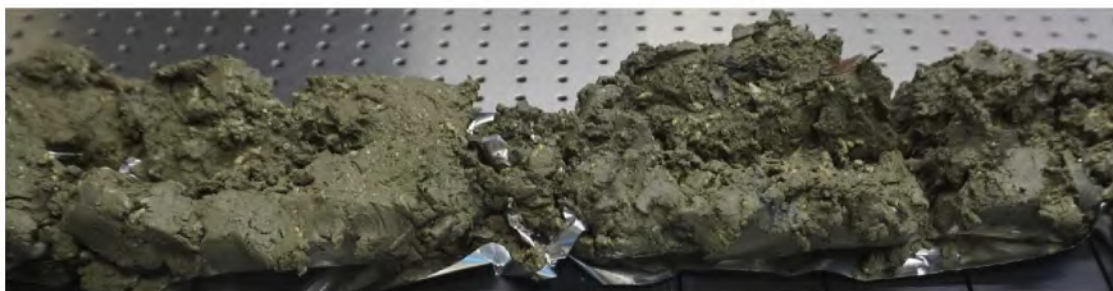
Figur 6: Bilde fra prøveåpning av BH.13, dybde 1,2-2,0m. Massene er siltig, sandig, leirig materiale med skjell og koraller.
