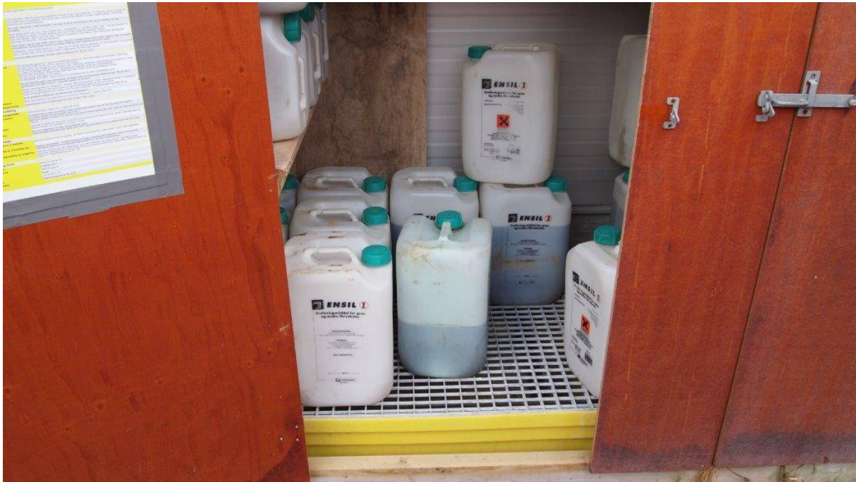
Figur 4. Oppbevaring av maursyre i utendørs skap, med oppsamling.
