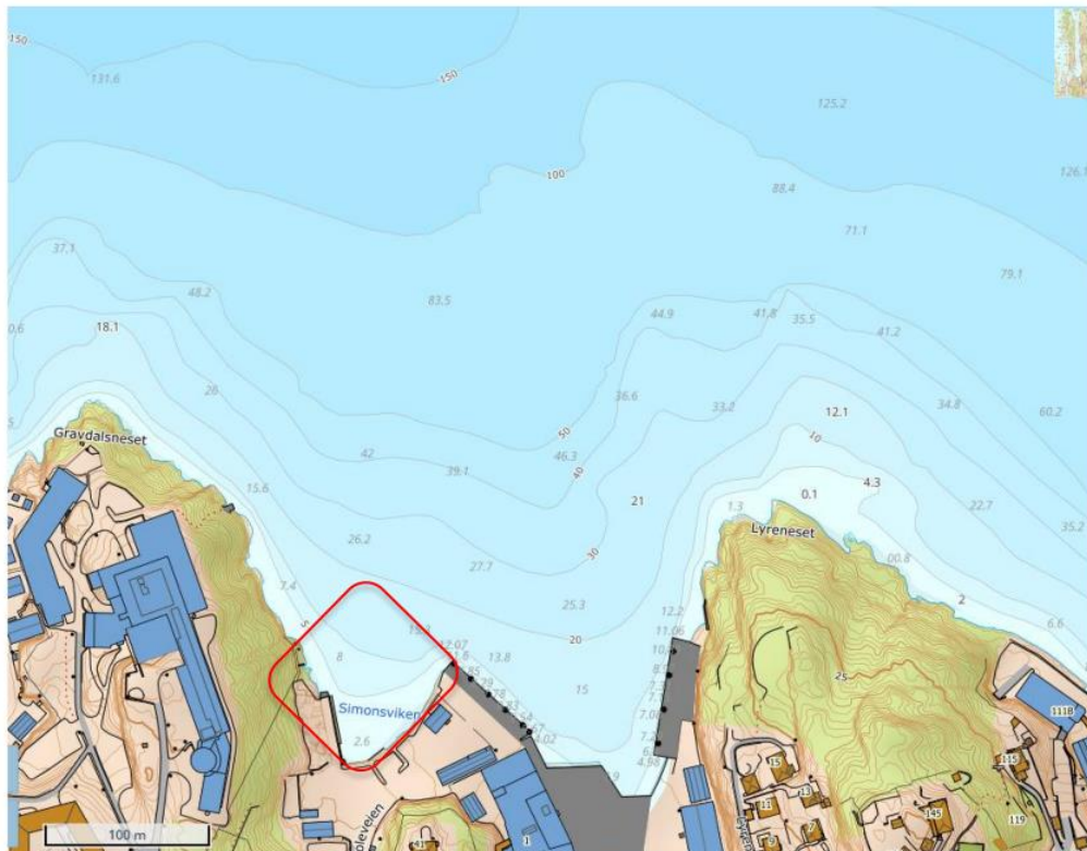
Figur 1. Oversiktsbilde over Simonsviken med dybdemålinger. Rød firkant viser ca. område for utfylling.
