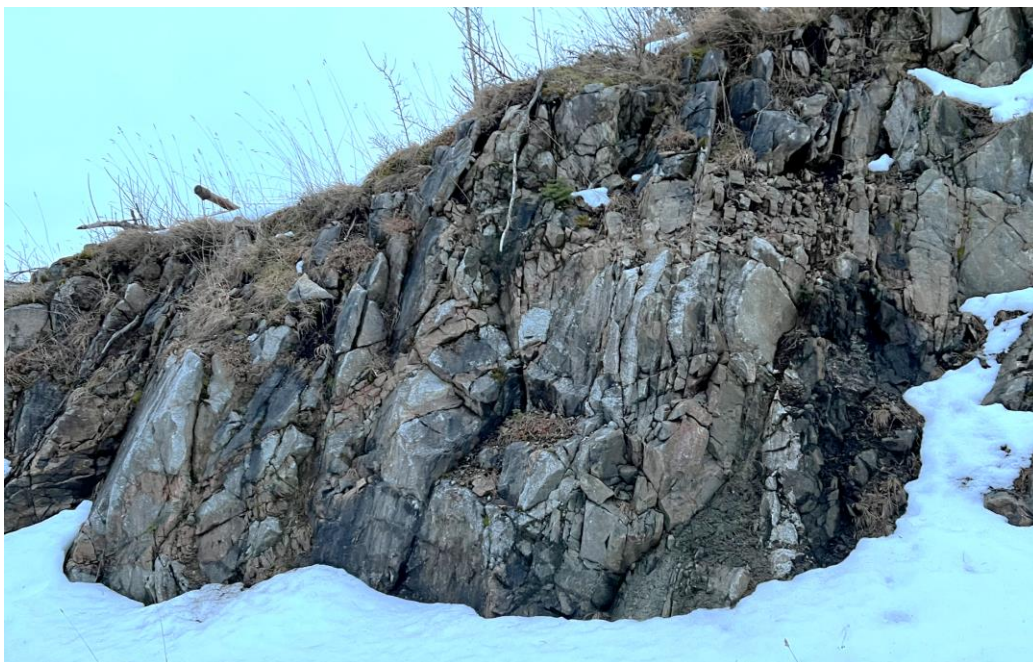
Figur 30: Bergmassen i første (sørlige) del av strekningen med profil 280-340, venstre side. Oppknuste soner ligger som «belter» i bergmassen.
