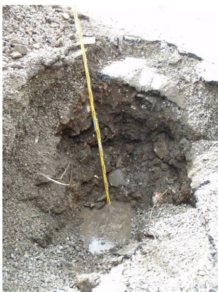
Figur 12: PG 12 er avsluttet i løsmasser ca. 1,8 m under terreng. Det var oljeskimmer på vannet som kom fram i bunnen av gropen. I fyllmassene ble det bl.a. observert teglstein, betongrester, jernskinner og armeringsjern.
