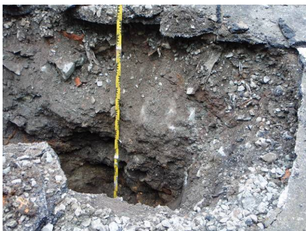
Figur 11: PG 11 er avsluttet i løsmasser i dybde 2,2 til 2,3 m under terreng. Fyllmassene var til dels mørke på farge, og det ble observert teglsteinsrester, litt plastfiller og en skosåle.
