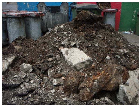
Figur 11: PG 11 er avsluttet i løsmasser i dybde 2,2 til 2,3 m under terreng. Fyllmassene var til dels mørke på farge, og det ble observert teglsteinsrester, litt plastfiller og en skosåle.
