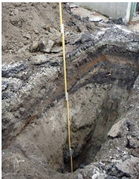
Figur 13: I PG 13 ble det funnet fyllmasser av produksjonsavfall (aske og slagg). Graving ble avsluttet i fyllmasser 2,6-2,7 m under terreng.
