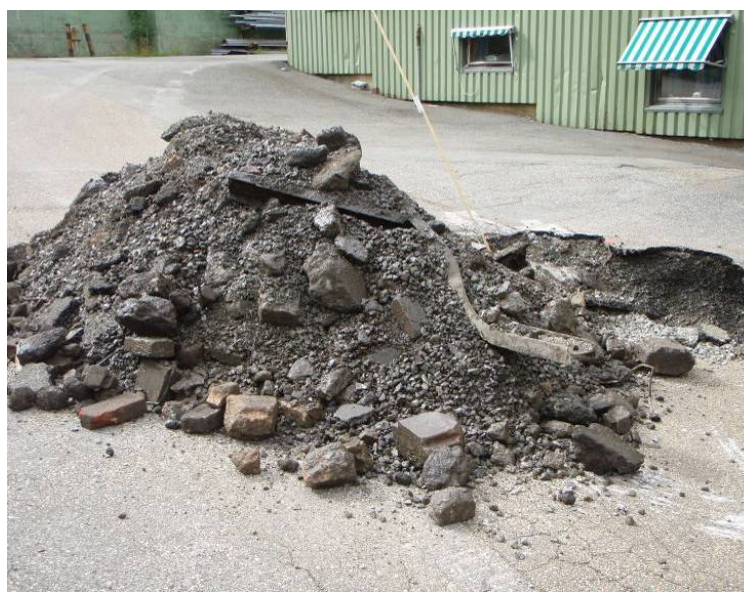
Figur 12: PG 12 er avsluttet i løsmasser ca. 1,8 m under terreng. Det var oljeskimmer på vannet som kom fram i bunnen av gropen. I fyllmassene ble det bl.a. observert teglstein, betongrester, jernskinner og armeringsjern.
