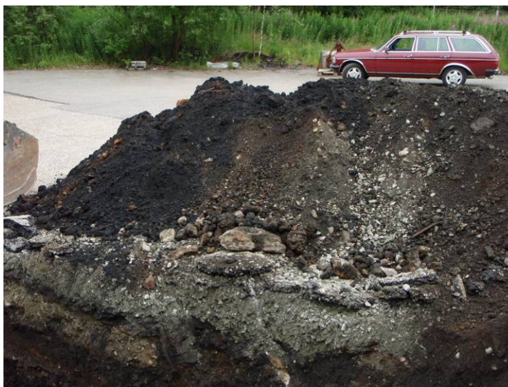
Figur 14: Også i PG 14 bestod løsmassene av fyllmasser fra produksjonen. Graving ble avsluttet i fyllmasser 2,9 m under terreng.
