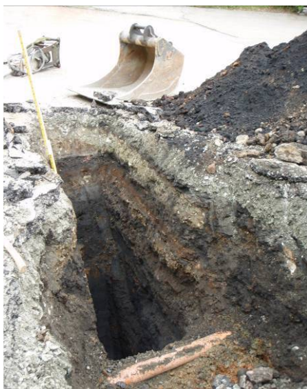
Figur 14: Også i PG 14 bestod løsmassene av fyllmasser fra produksjonen. Graving ble avsluttet i fyllmasser 2,9 m under terreng.
