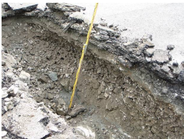
Figur 10: PG 10 er avsluttet mot antatt berg i dybde 1,2-1,3 m under terreng.
