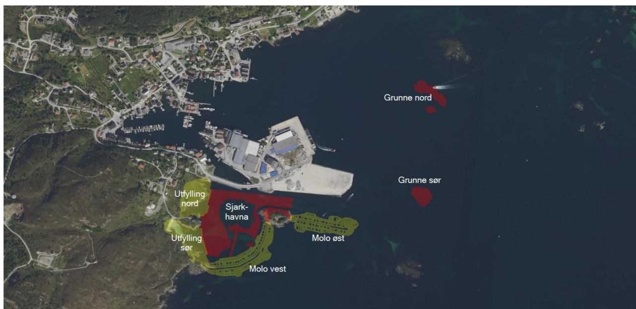
Figur 1: Kart over planlagt ny fiskerihavn (sjarkhavna) i Kalvåg. Markeringer i rødt viser områder som skal utdypes ved mudring og/eller sprenging og markeringer i gult viser områder som skal fylles ut.
