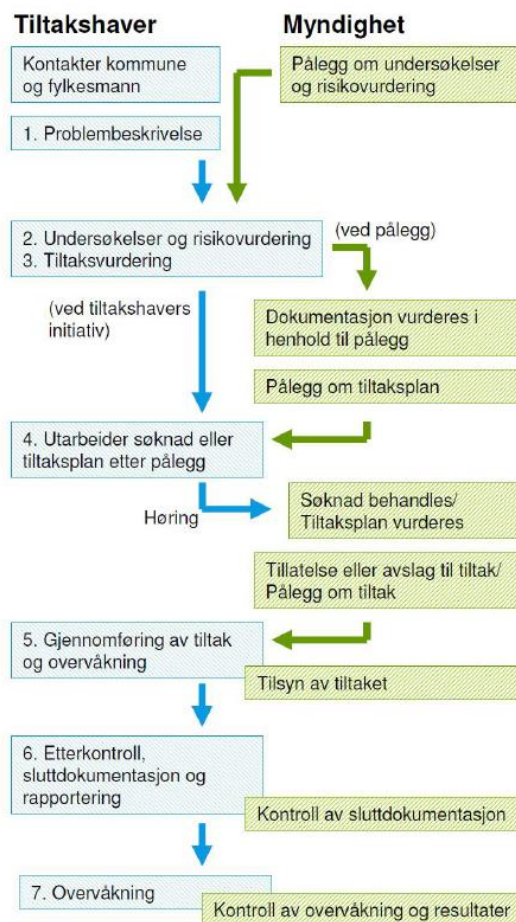
Figur 3: Utdrag fra M-350/2015, saksgang ved tiltak i sedimenter.
