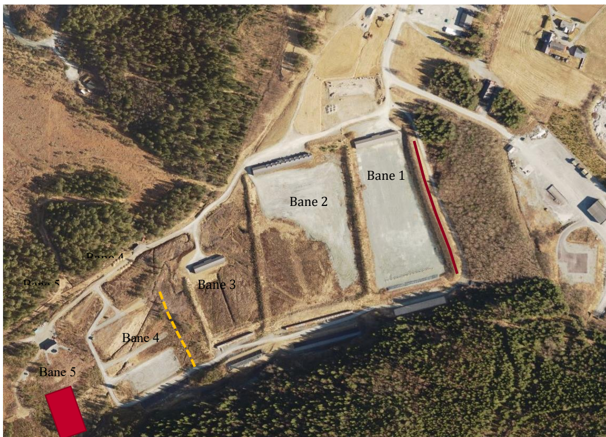
Figur 5 Område av eksisterende voll på bane 1 som kan heves for mulig økt støyskjerming (merket med rød linje). Mulig ny voll på bane 4 (merket med oransje linje). Eneste tilgjengelig plassering av mulig kortholdbane (markert med rød firkant)
