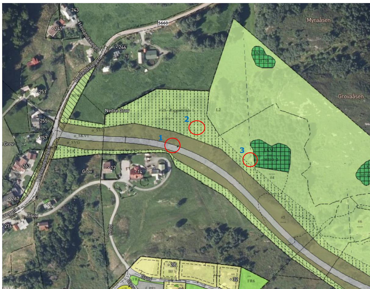
Figur 9. Registrerte brønner ved Grov (markert med rød sirkel og nummer). Borehull nr. 1 berøres høyst sannsynlig av planlagt trasé.
