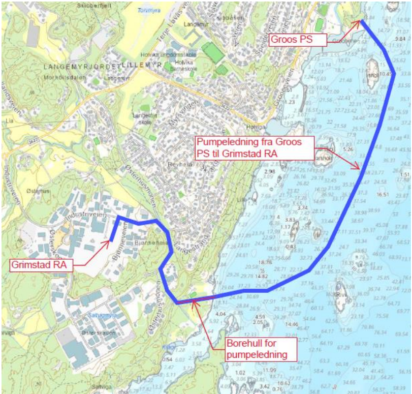
Figur 24 Ytre trasé for pumpeledning fra Groos PS til nye Grimstad RA (Asplan Viak, februar 2025)
