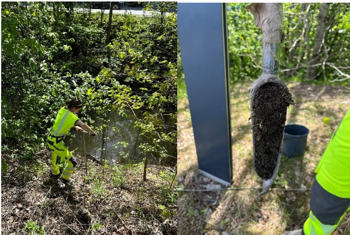
Figur 6. Figuren viser prøvetaking i skråningen med håndholdt bor.
