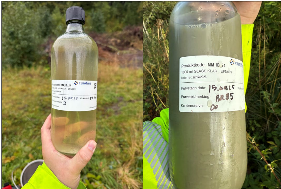
Figur 6: Eksempelbilder av prøvetatt vann fra brønn 3 (venstre) og brønn 5 (høyre). Bildene viser vann med hhv. lavt og høyt partikkelinnhold, sammenlignet mellom prøvetakingspunkter.
